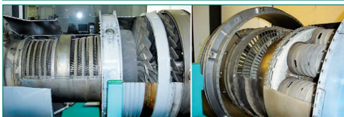
Рис. 1.77 Двигатель PW TF30-P-408. Вентилятор и компрессор
