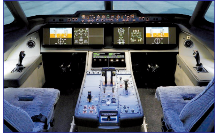
Рис. 4 Расположение терминалов систем бортового радиоэлектронного оборудования в кабине экипажа импортзамещённого ближнемагистрального реактивного самолёта "Sukhoi Superjet New"
