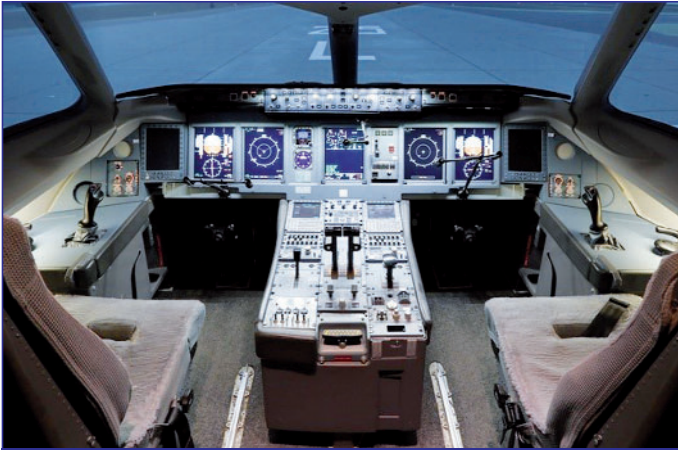
Рис. 2 Расположение терминалов систем бортового радиоэлектронного оборудования в кабине экипажа российского ближнемагистрального реактивного самолёта "Sukhoi Superjet 100"
