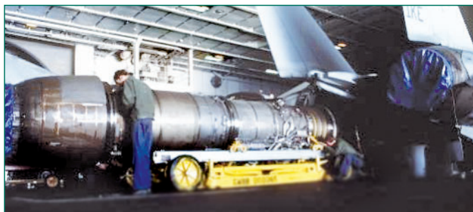
Рис. 1.82 Подготовка TF30-P-412A к установке на F-14A в ангаре авианосца
