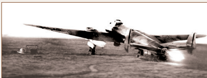
Опробование двигателя РД-1 на самолете Пе-2
