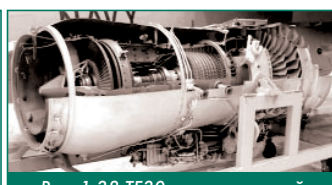
Рис. 1.38 TF30 - двухроторный ТРДДФ со смещением потоков
