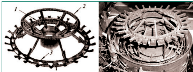
Рис. 1.62 Стабилизаторы пламени форсажной камеры TF30-P-1. В поздних модификациях (слева) кольцо 3 (стабилизатор горения зоны 1) было расширено и снабжено завихрителями, а кольца 1 и 2 (стабилизатор горения зоны 5) поменяли своё расположение [31, 37]
