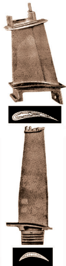
Рис. 1.59 Сопловая и рабочая лопатки первой ступени ТНД ТРДДФ TF30-P-100 [30]
