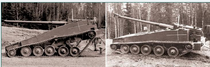
Опытный макет танка UDES 03 при различных положениях корпуса
