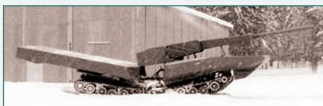
При горизонтальной наводке поворачивалась передняя секция при помощи соответствующих переключений гидроцилиндров шарнира. Также осуществлялась вертикальная наводка путем наклона секций.
