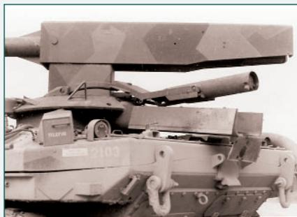
Параллельно на одном из серийных Strv 103 отрабатывался автомат заряжания. Проведенные испытания подтвердили возможность работы лафетной установки в различных условиях, в том числе и при попадании небольших посторонних предметов в механизмы автомата заряжания.
