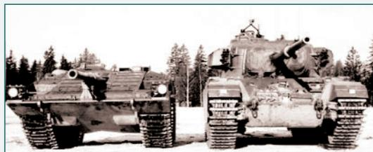
Вид спереди танков Strv 103 и Strv 101 (Centurion Mk 10)
