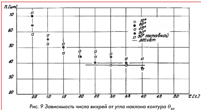
Рис. 9 Зависимость числа вихрей от угла наклона контура  $\theta_{вх}$
