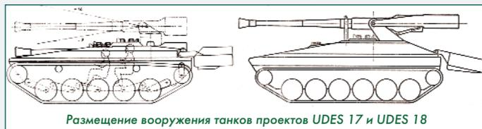
Размещение вооружения танков проектов UDES 17 и UDES 18
