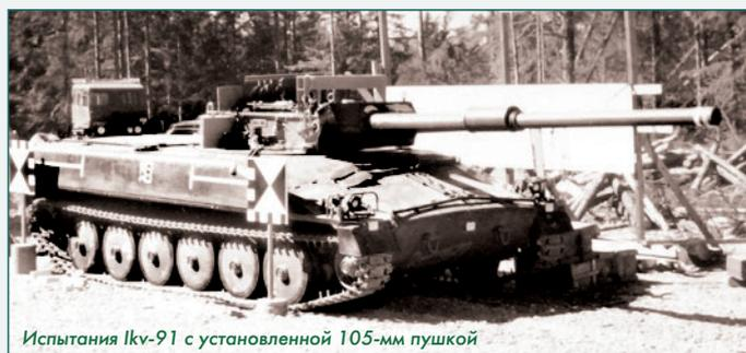
Испытания Ikv-91 с установленной 105-мм пушкой
