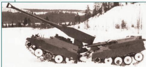
Проверялась и возможность сочленённого танка по дополнительному увеличению угла вертикальной наводки.
