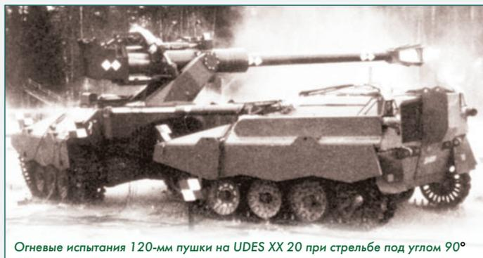
Огневые испытания 120-мм пушки на UDES XX 20 при стрельбе под углом  $90^\circ$
