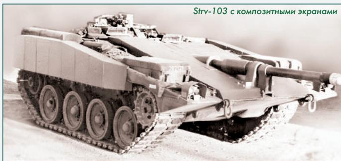
Strv-103 с композитными экранами
