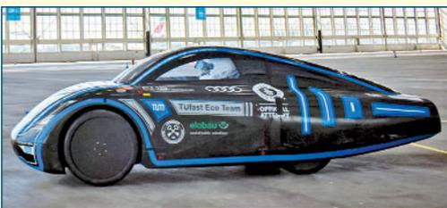
В основе конструкции кузова электромобили Muc022 лежит углепластиковый монокок, усиленный алюминиевыми панелями с сотовой структурой, масса которого всего 18,6 кг (масса Muc022 без водителя всего 170 кг, а без аккумулятора - 74 кг). Коэффициент аэродинамического сопротивления ( $c_x$ ) всей конструкции снижен до 0,159 при габаритной длине - 3,4 м, ширине - 1,2 м, высоте - 1,0 м. Углепластиковые колёса снабжены тонкими шинами с пониженным сопротивлением качению. Конструкция рулевого
