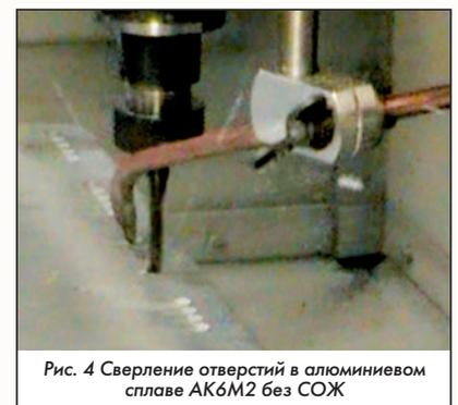
Рис. 4 Сверление отверстий в алюминиевом сплаве АК6М2 без СОЖ
