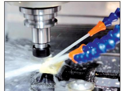
Рис. 3 Обработка отверстий на вертикально-сверлильном станке с использованием смазочно-охлаждающей жидкости
