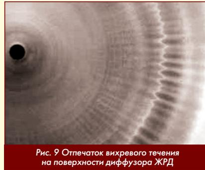
Рис. 9 Отпечаток вихревого течения на поверхности диффузора ЖРД
