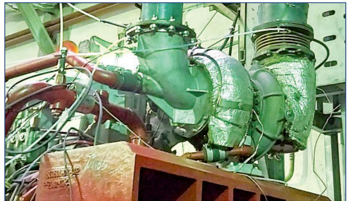
Рис. 8 Турбокомпрессор ТКР201 дизеля 6ДМ-185Т на испытательном стенде № 4 ООО "УДМЗ"
