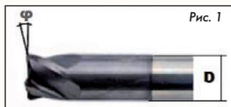
Угол в плане у режущей кромки  $\phi$  мал и меняется от  $15^\circ$  до нуля для чистовых фрез.
