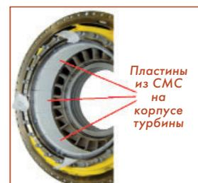
Пластины из СМС на корпусе турбины
