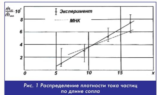
Рис. 1 Распределение плотности тока частиц по длине сопла
