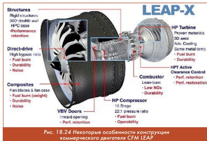
Рис. 18.24 Некоторые особенности конструкции коммерческого двигателя CFM LEAP
