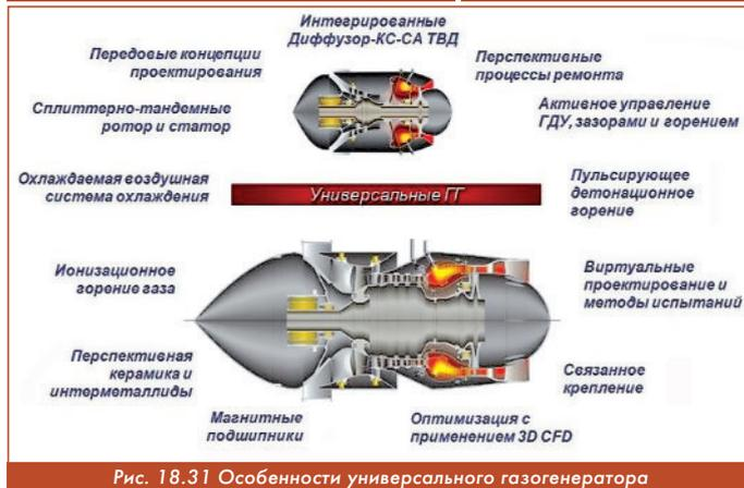
Рис. 18.31 Особенности универсального газогенератора
