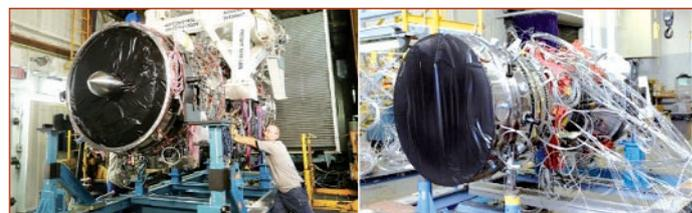
Рис. 18.21 Подготовка опытного образца двигателя XA100 к испытаниям
