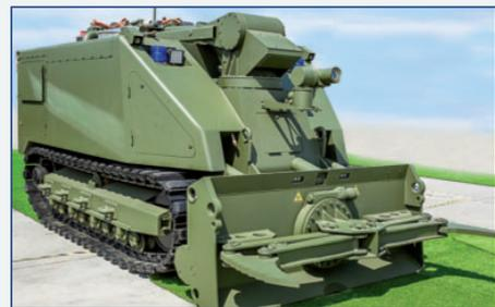
Рис. 3 Робототехнический комплекс "Уран-14"
