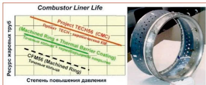
Рис. 18.9 Жаровая труба из композитных материалов с керамическими матрицами
