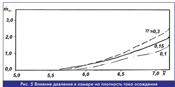
Рис. 5 Влияние давления в камере на плотность тока осаждения
