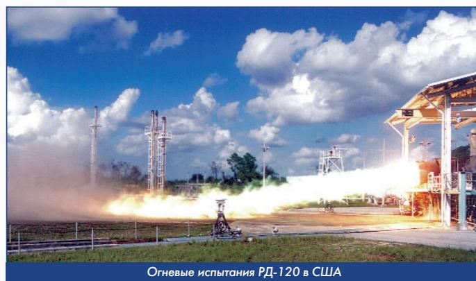
Огневые испытания РД-120 в США
