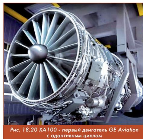
Рис. 18.20 XA100 - первый двигатель GE Aviation с адаптивным циклом
