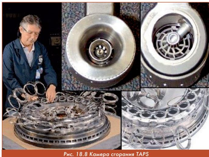
Рис. 18.8 Камера сгорания TAPS
