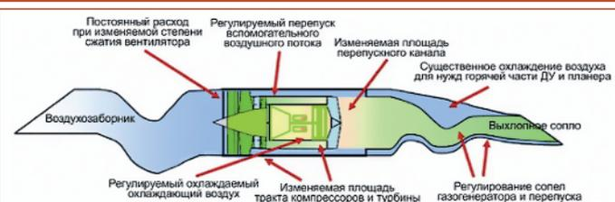
Рис. 18.17 Схема расположения основных элементов адаптивного двигателя
