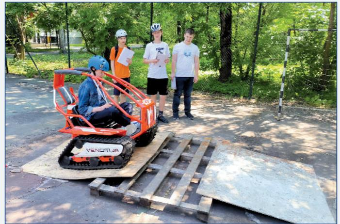
Рис. 14 Управление роботом с места водителя: преодоление препятствий
