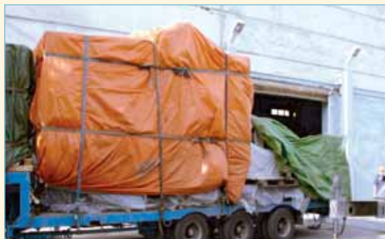
Это то, что на языке "Галики" называется экспортной упаковкой. Стропачные ремни давили на защитную кабину, деформировав и повредив ее во многих местах
