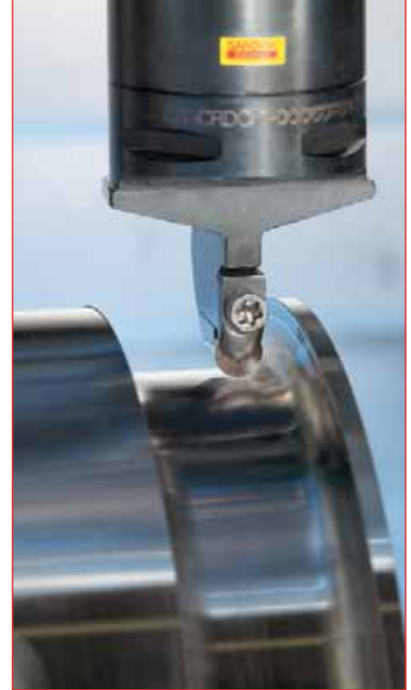
Рис. 6. Точение детали из жаропрочной стали инструментом, оснащенным пластиной из режущей керамики CC6065
