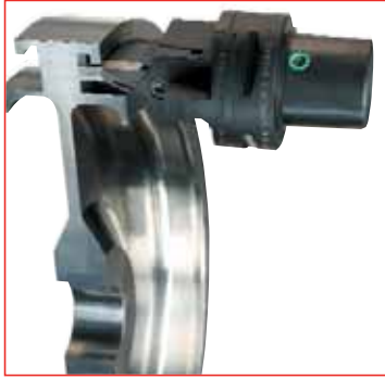
Рис. 3. Обработка G-образной канавки диска инструментом CoroCut со специальной пластиной
