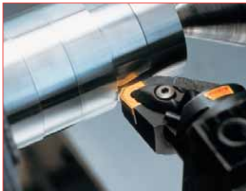
Рис. 2. Точение детали из жаропрочной стали, пластинами Xcel
