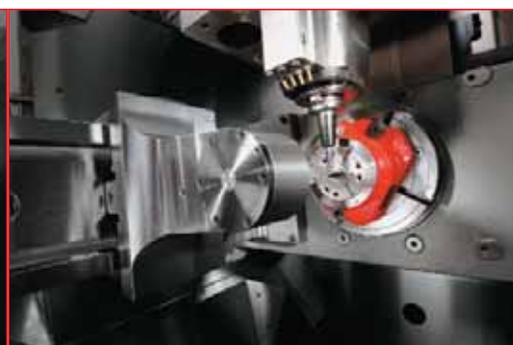
Обработка турбинной лопатки с использованием автоматической контропоры, установленной на наклонно-поворотном столе с ЧПУ станка С 30 U
