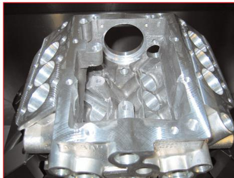
V-образный корпус топливного насоса высокого давления.
