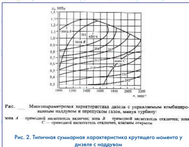
Рис. 2. Типичная суммарная характеристика крутящего момента у дизеля с наддувом
