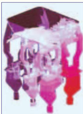
Моделирование процесса заливки блока турбинных лопаток
