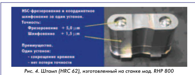
Рис. 4. Штамп (HRC 62), изготовленный на станке мод. RHP 800
