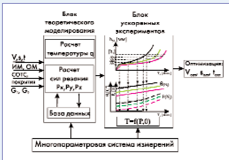
Рис. 3. Функциональная схема определения зависимости стойкости инструмента от режимов резания для пары "инструментальный / обрабатываемый материал" с помощью термосилового моделирования и многопараметровой системы измерений
