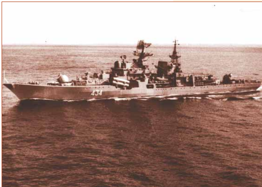
Современный российский эскадренный миноносец проекта 956 оснащен двумя турбозубчатыми агрегатами суммарной мощностью 100 000 л.с. Максимальная скорость корабля - 32 узла
