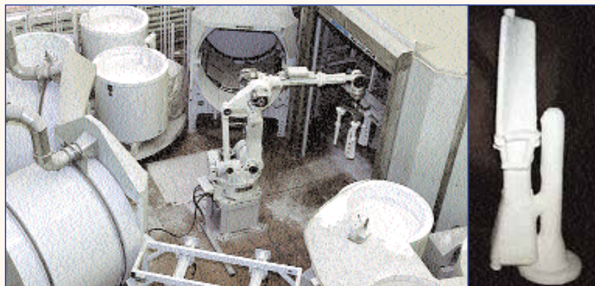
Роботизированный комплекс для изготовления керамических форм и керамическая форма с промежуточным эмалевым слоем для литья турбинных лопаток
