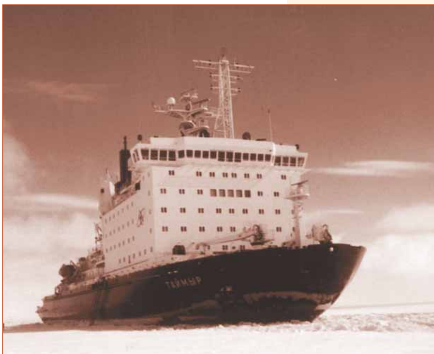
Мощность двухвальной главной энергетической установки атомного ледокола "Таймыр" составляет 54 000 л.с.
