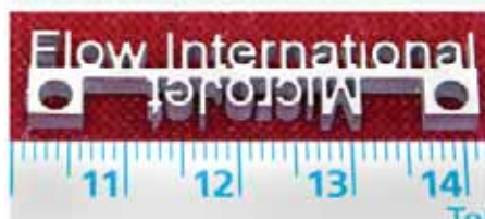
Пример гидроабразивного резания алюминиевого сплава
