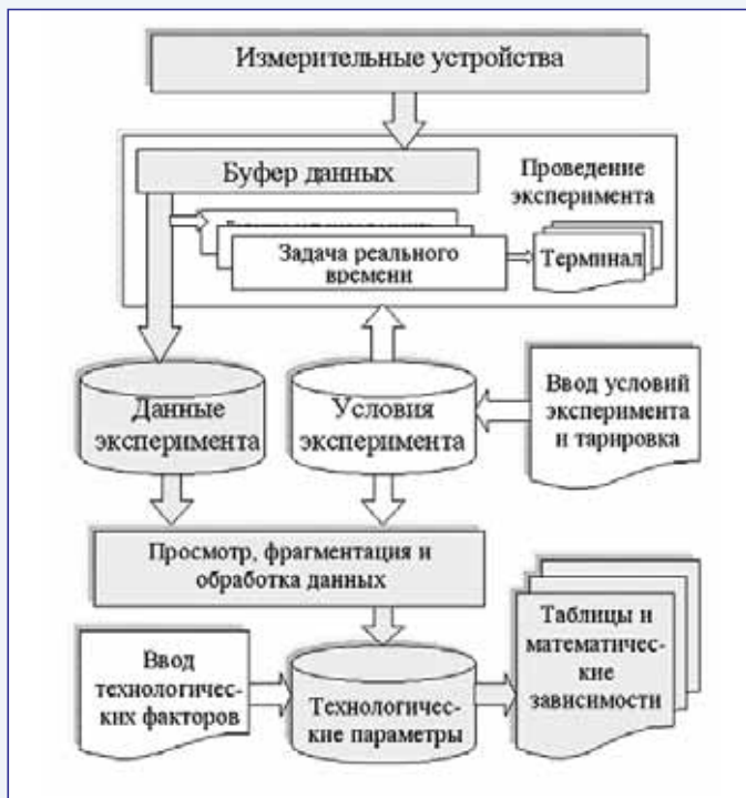
Рис. 3. Структура программного обеспечения многопараметровой измерительной системы в процессе резания
