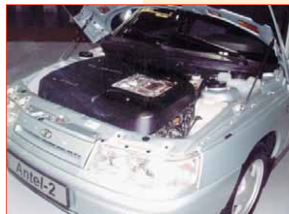
Экспериментальный автомобиль Antel-2, оснащенный топливными элементами
