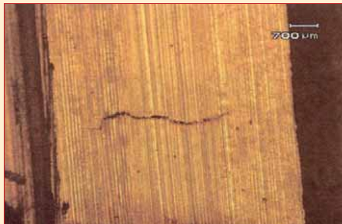
Рис. 2. Трещина на внутренней стороне барабана между IV и V ступенями
