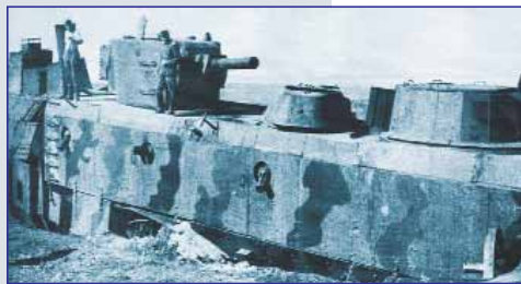
На этом броневагоне, захваченном немцами, смонтированы три артсистемы, в том числе 152-мм гаубица в башне танка KV-2 и 76-мм пушка в башне танка Т-34
