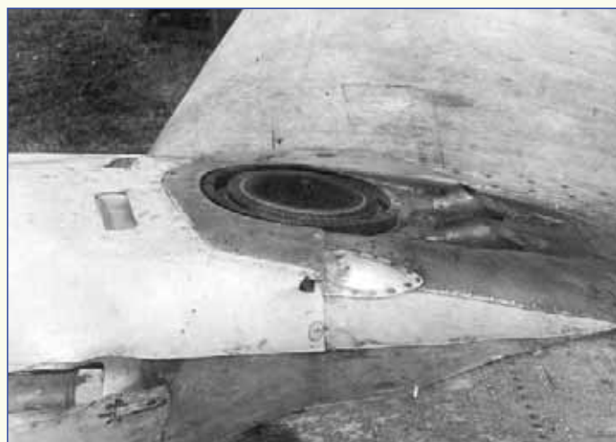
Турбокомпрессор ТК-2 на моторе М-105 опытного бомбардировщика СБ
