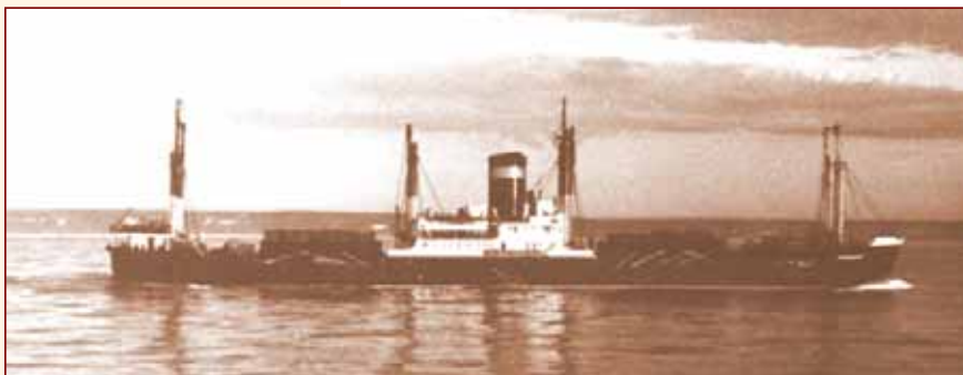
Судно типа "Донбас" с паровой машиной двойного расширения
