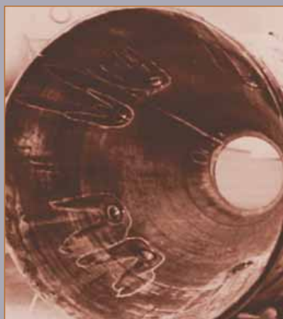
Рис. 4. Следы уноса материала за управляющими клапанами после испытания
