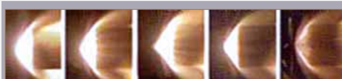
Рис. 1. Динамика разрушения образца в струе плазмотрона
