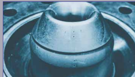
Рис. 3. Повернутое дозвуковое сопло после эксперимента
