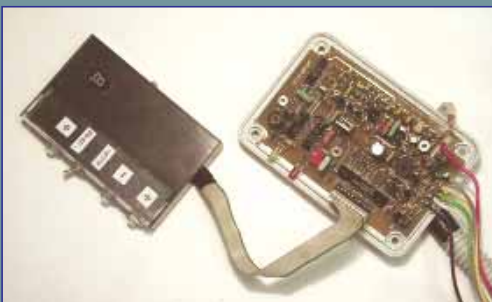
Рис. 3. Блок измерения со снятой крышкой и подсоединенным программатором, обеспечивающим необходимую точность градуировки прибора
