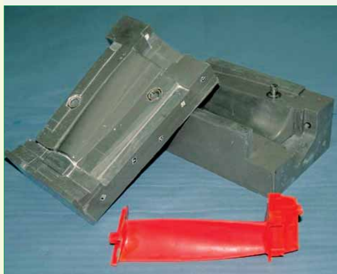
Металлополимерная пресс-форма для изготовления "восковок" лопатки компрессора
