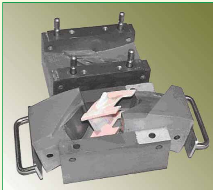
Металлополимерная пресс-форма для изготовления "восковок" сопловых лопаток
