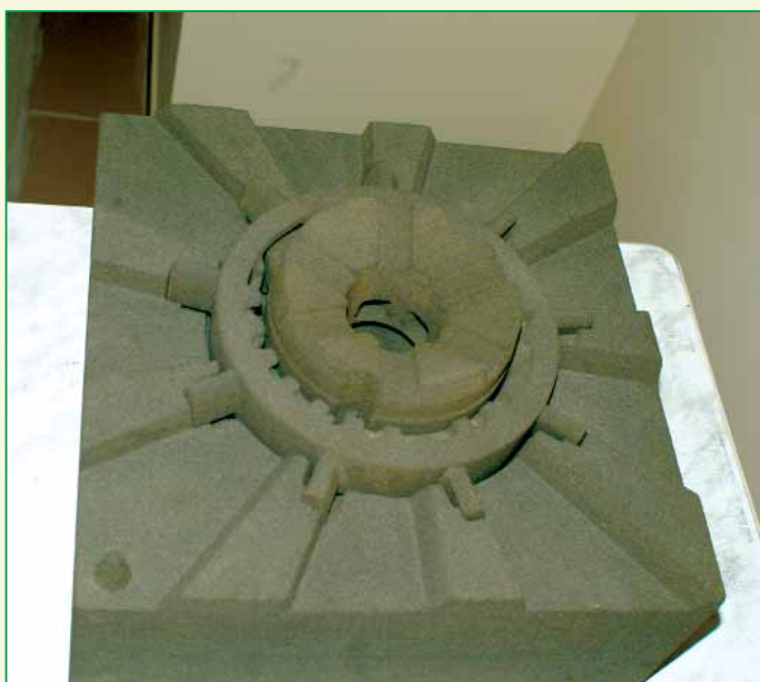
Элемент песчаной формы, полученной на установке селективного отверждения песчаной смеси S15
