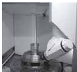
Рис. 5. Изготовление корпусного кольца реактивного двигателя на станке UNICOM 6000-HV
