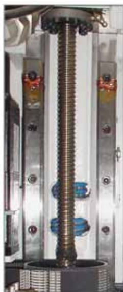
Привод с ШВП и ременным редуктором в швейцарском ЭИ станке.
