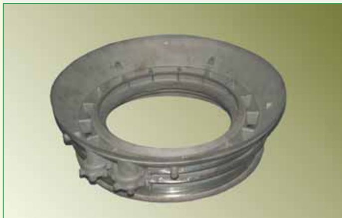
Отливка диффузора, полученная по выжигаемой модели
