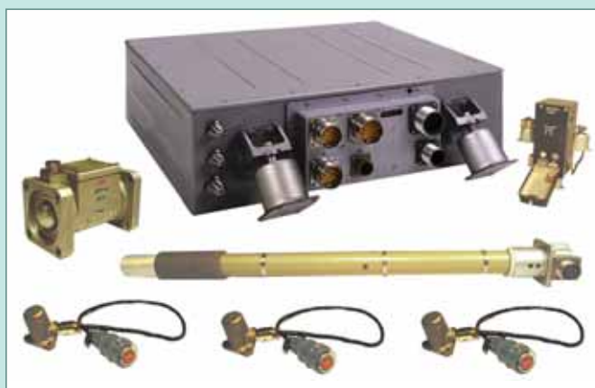
БСКД90 - система бортового контроля авиадвигателей
