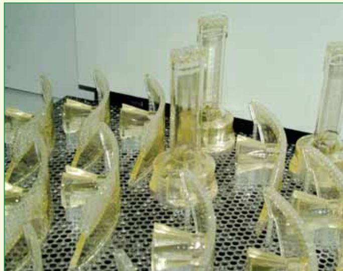
Платформа построения установки SLA - 7000 после процесса "выращивания" моделей
