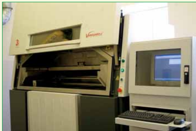
Общий вид установки селективного лазерного спекания Vanguard Si2 HS
