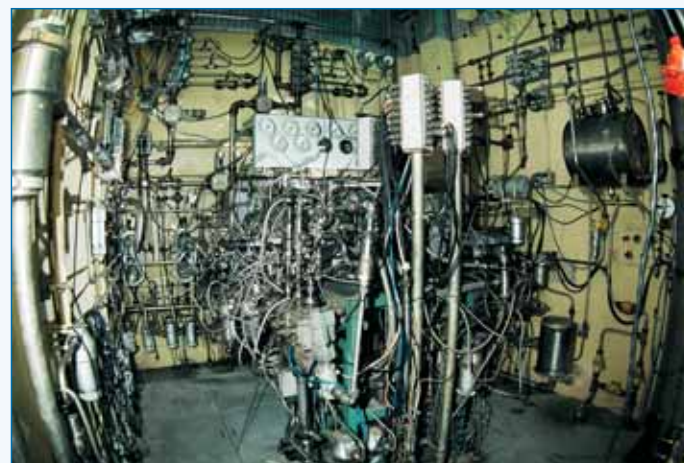
Стенд для полунатурных испытаний АСУ ГТД
