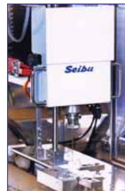
Рис. 8. Устройство прошивки стартовых отверстий типа Ana-aka Taro
