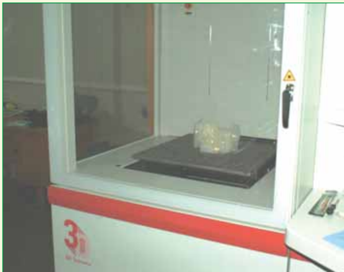
Вид камеры построения установки SLA - 7000
