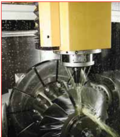
Обработка "моноколеса" на "Xceeder-1200/RT"
