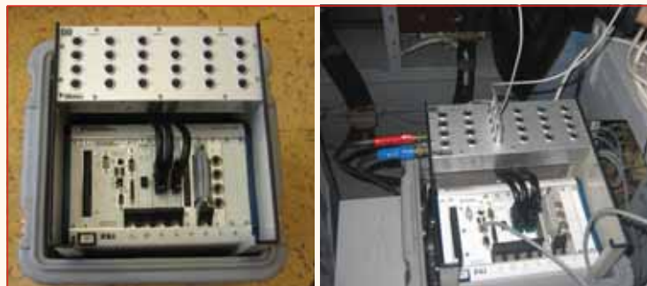
Рис. 1. Система для проведения испытаний электрических двигателей локомотивов, выполненная в специализированном ударопрочном корпусе
