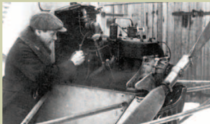
Обслуживание силовой установки аэросаней КМ-5
