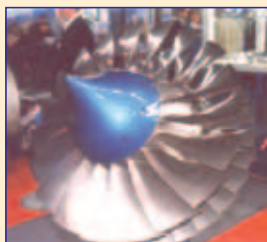
Новый ротор компрессора низкого давления для АИ-222-25
