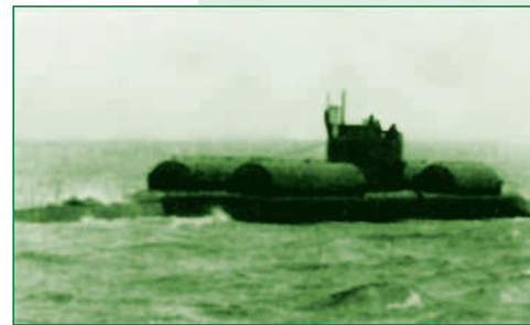
Подводная лодка проекта 613Э с электрохимическим генератором на испытаниях
