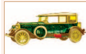
В начале XX века было построено несколько сотен автомобилей с паровыми двигателями, среди которых американский "Добль". Плавное ускорение машины, подобно тому, как это делает железнодорожный экспресс, можно было создавать через 30 секунд после включения зажигания. Двигатель мог работать на нефти, угольной смоле, мазуте, газолитине, керосине.
