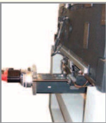
Привод с ШВП и ременным редуктором швейцарского ЭЭ станка
