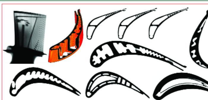
Рис. 6. Примеры результатов томографического контроля охлаждаемых турбинных лопаток ГД
