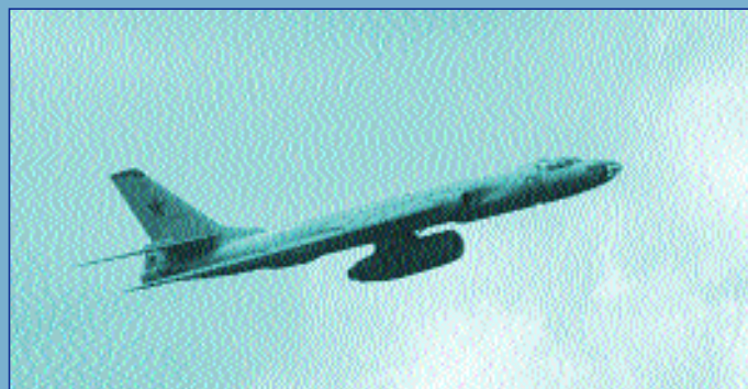
Летающая лаборатория Ту-16 для проведения летных испытаний двигателей
