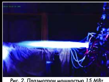
Рис. 2. Плазмотрон мощностью 15 МВт
