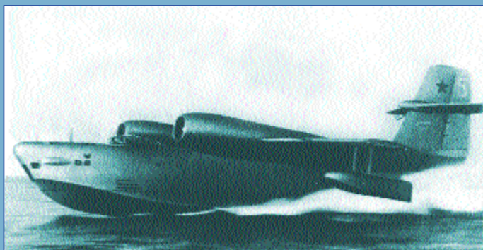
Летающая лодка Р-1 с двигателями ВК-1
