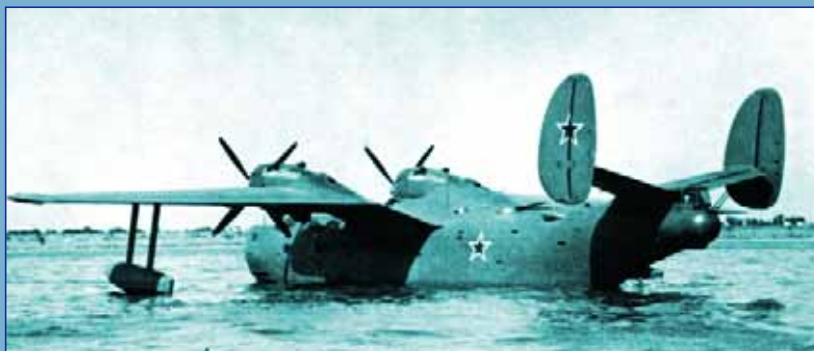
Летающая лодка Бе-6 с моторами АШ-73
