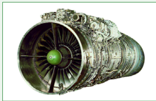
Двухконтурный ГТД фронтального истребителя
