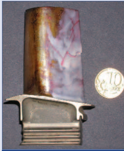
Рис. 3. Усталостные трещины в лопатке МОНО
