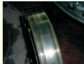
Рис. 11. Наружная обойма со следами проскальзывания
