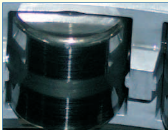
Рис. 10. Ролик промежуточного подшипника со следами износа
