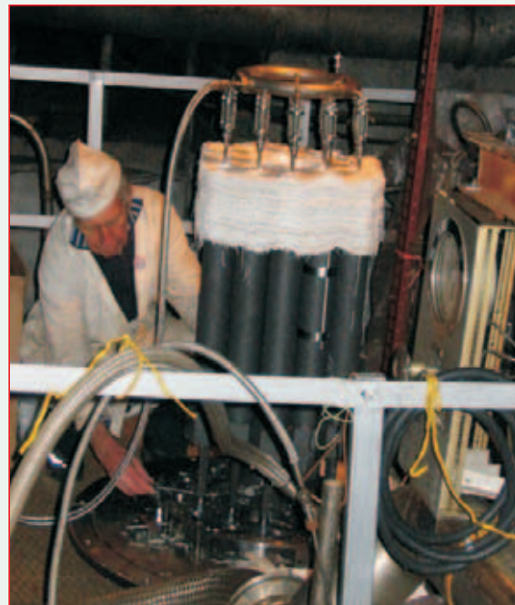
Сборка теплового аккумулятора на испытательном стенде
