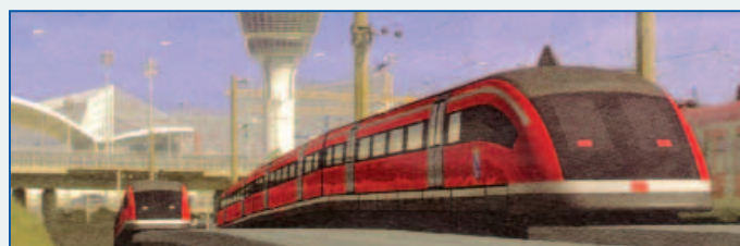
Рис. 6. Поезда системы TPANSRAPID, фирмы Krauss-Maffei AG. Длина вагона, м..... 12 Ширина, м..... 2,09 Высота над плоскостью пути, м..... 2,05 Масса, т..... 11 Расчетная скорость, км/ч..... 400 Достигнутая скорость, км/ч..... 160
