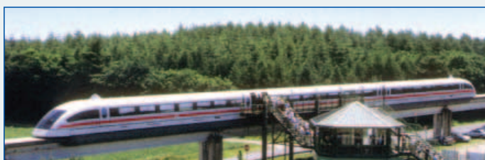
Рис. 5. Посадка на поезд линии с бесконтактным магнитным подвешиванием разработки Messerschmitt-Bolkow-Blohm GmbH (MBB), окрестности Мюнхена. Длина вагона, м..... 7,6 Пусковое тяговое усилие, кгс..... 1000 Ширина, м..... 2,1 Номинальная мощность, кВт..... 174 Высота, м..... 1,8 Привод - линейный асинхронный электродвигатель Порожняя масса, т..... 5,2 Вместимость, мест..... 8
