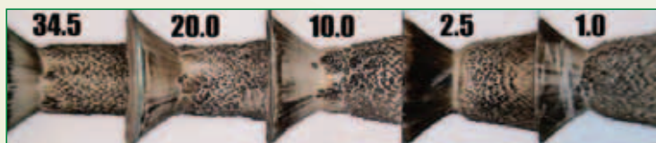
Рис. 3. Зависимость величины разгара сопел от длины цилиндрической образующей вкладыша L
