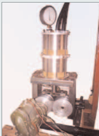
Проектные параметры двухпоршневого компрессора 2-ПК
