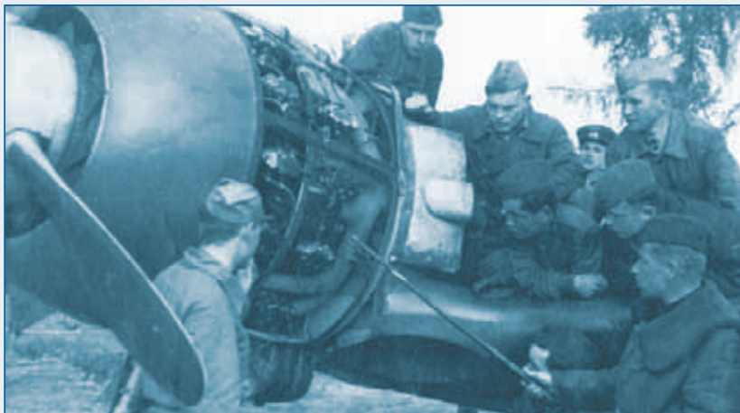
Изучение конструкции силовой установки истребителя Ла-5 с мотором М-82Ф
