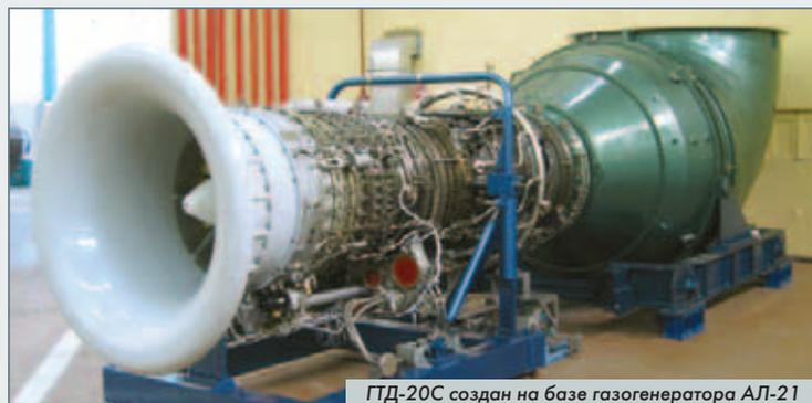
ГТД-20С создан на базе газогенератора АЛ-21
