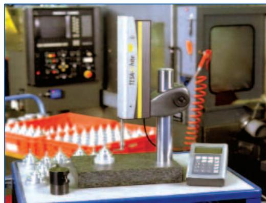
Вертикальные длинномеры MICRO-HITE® предназначены для измерения в условиях заводских цехов внешних и внутренних размеров, высоты, глубины, шага и расстояния до элементов, имеющих плоскую или цилиндрическую поверхность. Измеренные параметры автоматически записываются. При поставке с необходимым набором аксессуаров длинномеры могут использоваться в качестве двухкоординатных измерительных машин.
