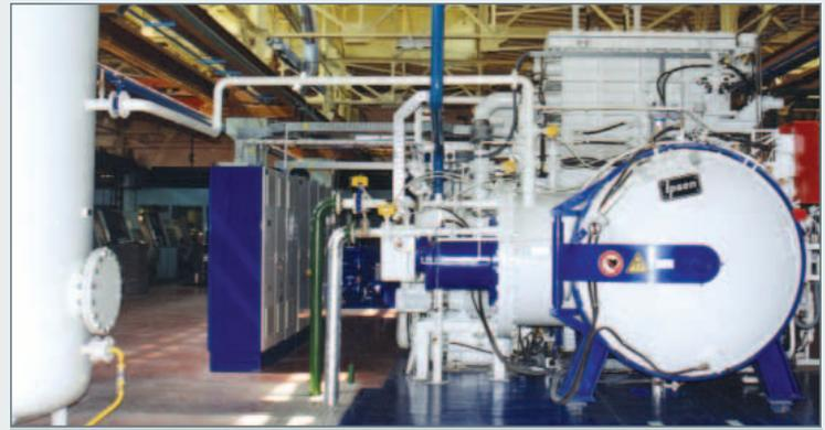
Трехкамерная печь фирмы "Ипсон" на участке ионной и химико-термической обработки
