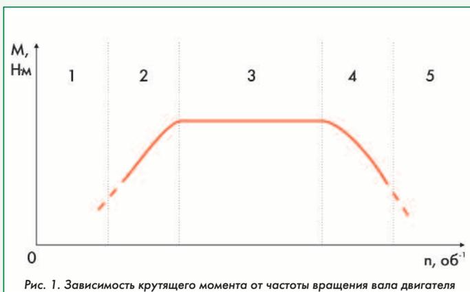
Рис. 1. Зависимость крутящего момента от частоты вращения вала двигателя
