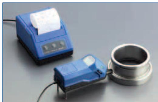
Прибор первого класса точности "ХОММЕЛЬ" предназначен для контроля шероховатости поверхности. Он обеспечивает мобильный (благодаря питанию от сменного аккумулятора напряжением 9 В) сбор данных и их передачу в компьютер для дальнейшей обработки.
