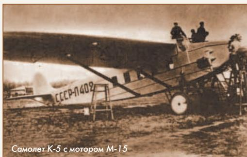
Самолет К-5 с мотором М-15
