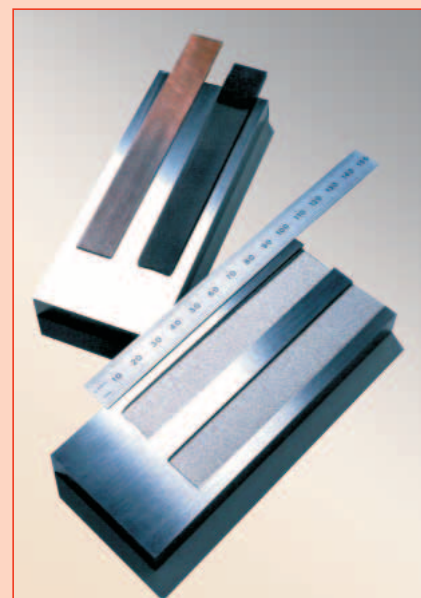
Пазы, обработанные по технологии RIB медным (слева) и графитовым (справа) электродами. Результаты тестов при обработке графитовым электродом: глубина паза 100 мм, материал детали - сталь, материал электрода - мелкозернистый графит. Сечение электрода 1x15 мм, конусность 1°. Обработка без прокачки. ROBOFORM 35P: 05:37:00 / Торцевой износ 2,65 мм ROBOFORM 350: 04:45:00 / Торцевой износ 0,99 мм
