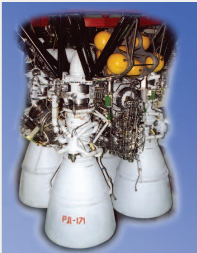
Двигатель РД-171 первой ступени РН "Зенит-2" для программы "Морской старт"
