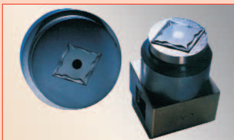
Обработка твердых сплавов по технологии К-НМ. Пресс-форма из твердого сплава, электрод - композитный материал "медь-вольфрам". Шероховатость поверхности Ra 0,12 мкм, точность ± 0,005 мм.
