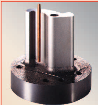
Контурная обработка. Пуансон вырубного штампа. Материал детали - сталь. Материал электрода - медь. Шероховатость поверхности Ra 1,12 мкм
