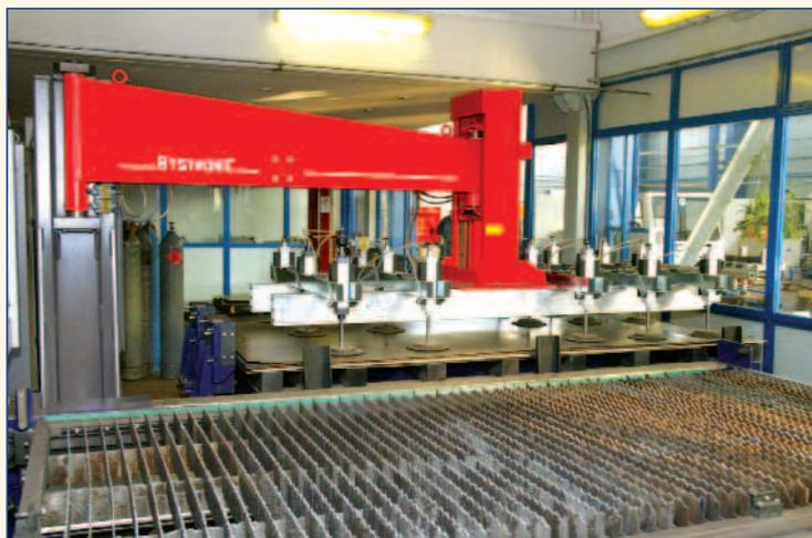
Рис. 1. Установка для лазерного раскроя листовых материалов
