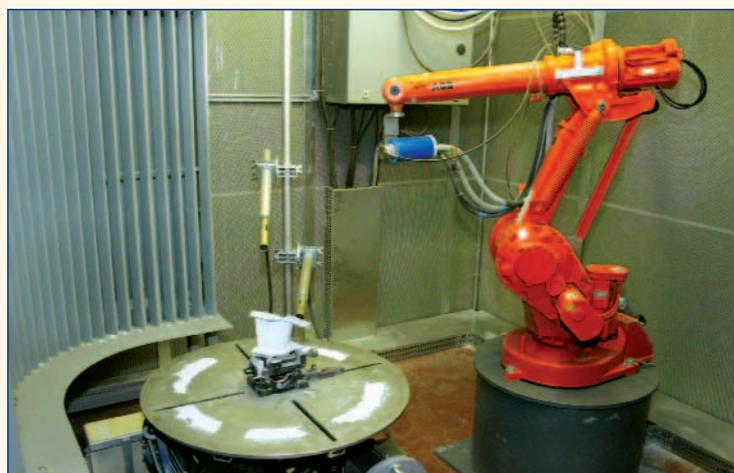
Рис. 5. Робот-манипулятор для нанесения плазменных теплозащитных покрытий
