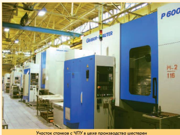
Участок станков с ЧПУ в цехе производства шестерен
