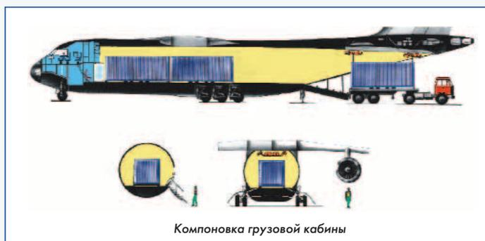
Компоновка грузовой кабины
