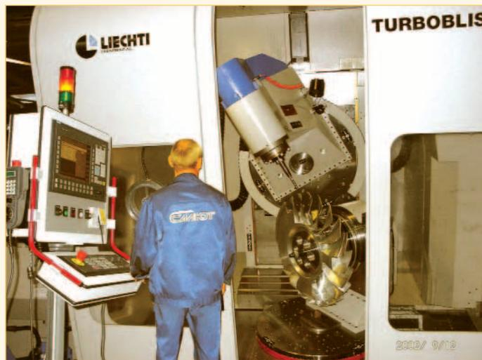
Обработка моноколеса компрессора двигателя на станке "Турбоблиск"
