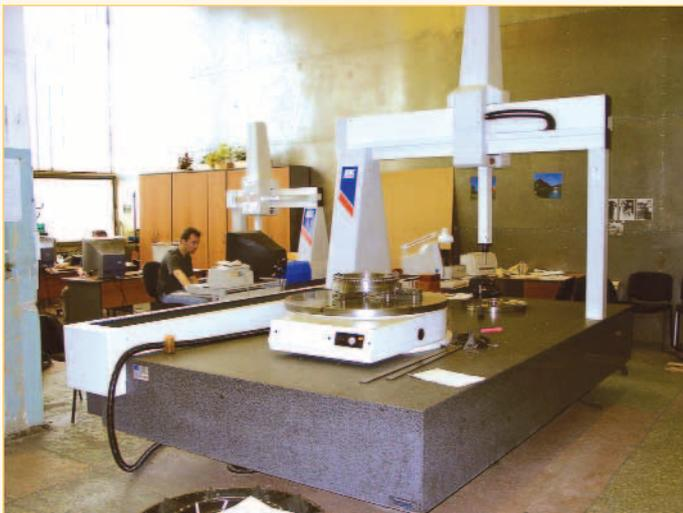
Контрольно-измерительная машина с ЧПУ, установленная в механическом цехе
