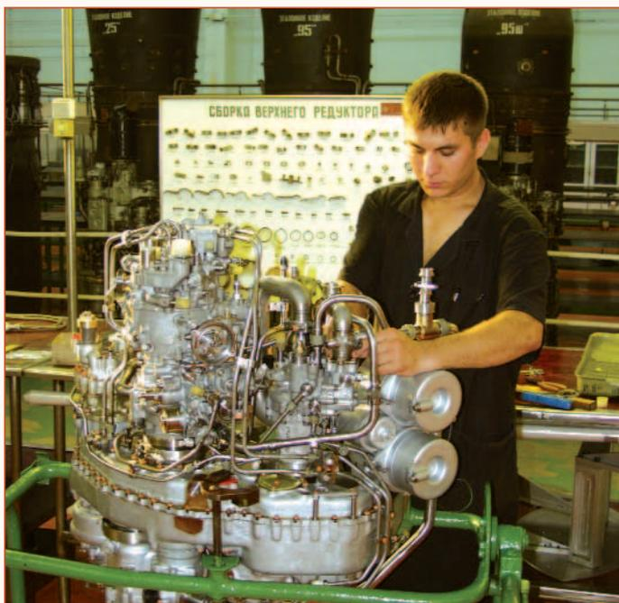
Участок сборки верхнего редуктора двигателя АЛ-31Ф
