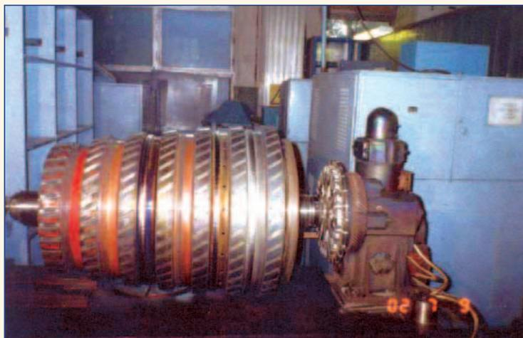
Рис. 3. Ротор компрессора ДЖ-59 после электронно-лучевой наплавки
