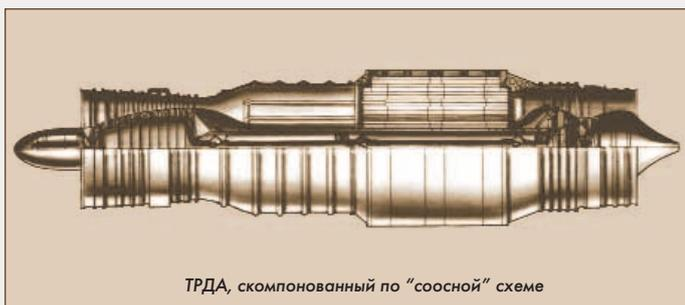
ТРДА, скомпонованный по "соосной" схеме
