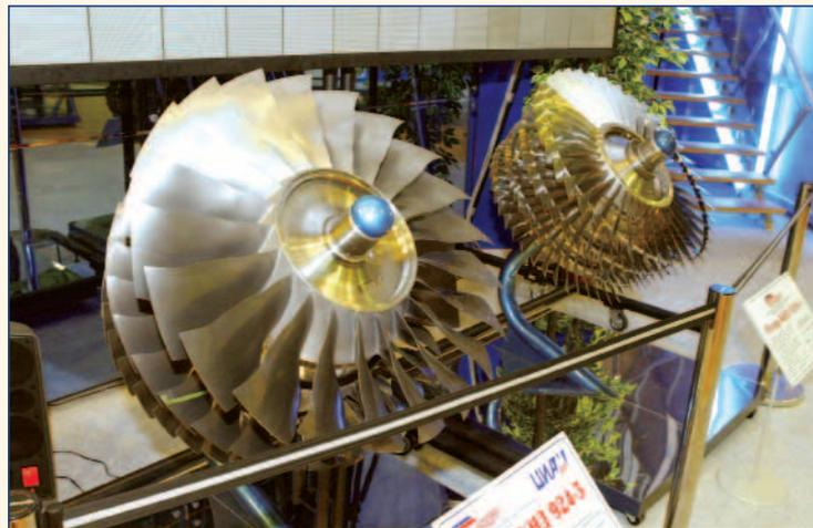
Рис. 2. Трехступенчатый ротор с блиск-ступенями
