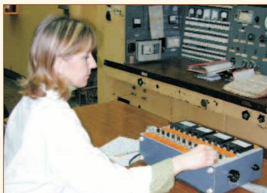
Дистанционный переносной пульт управления системой отбора проб воздуха
