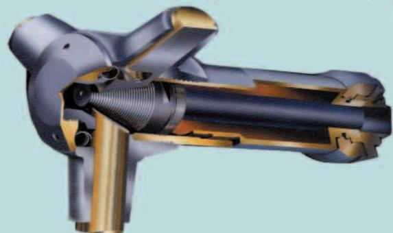
**Нутромер IMICRO** - самоцентрирующийся и самовыравнивающийся инструмент. В зависимости от модели с помощью нутромера можно измерять диаметр сквозных и глухих отверстий.
