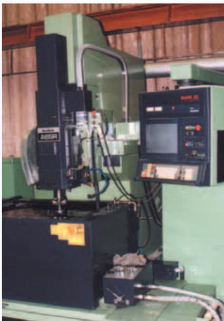
микротвердости поверхностного слоя и специфической микрогеометрии поверхности, хорошо удерживающей смазку. Описанным выше способом на ЭЭ участке инструментального производства ММПП "Салют" обрабатываются гравюры штампов, шаблоны, цанги, фильтры, фасонный режущий инструмент, сложно-фасонные профили электродов и другие детали оснастки различного назначения сложной конфигурации.
