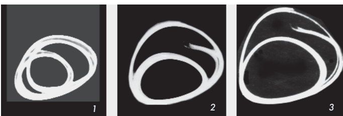
Рис. 6. Деформация траекторий движения конца вала ТНА при разрушении подшипника:
