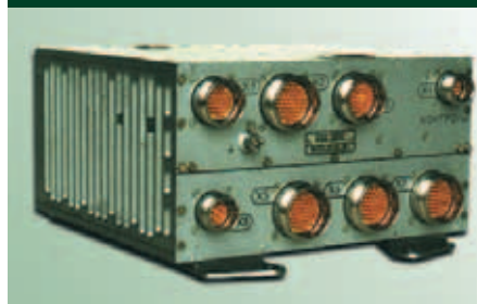
Электронный регулятор РЭД-2000 силовой установки самолета Ан-140
