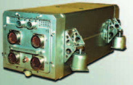
Электронный регулятор РЭД-90 двигателя ПС-90А
