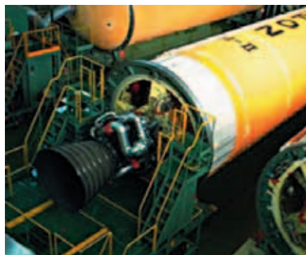
LE-7, установленный в ракету
