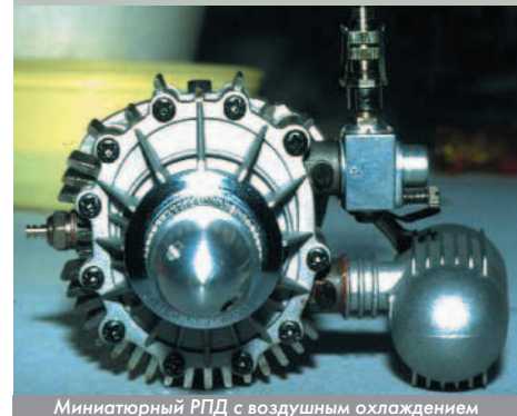
Миниатюрный РПД с воздушным охлаждением
