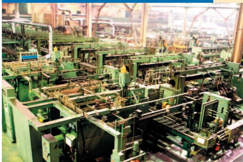
Автоматическая линия обработки коленвала двигателя УЗАМ
