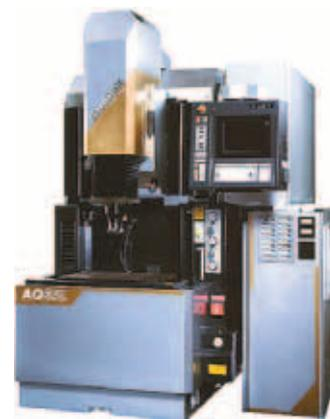
Обычные приводы из-за больших потерь в механизмах преобразования вращательного движения в линейное, инерционности и т.д. обеспечивают подачу электрода в командные точки лишь с точностью в "десятку" или, в лучшем случае, в "сотку". В результате ЭЭ станок с обычными приводами только малую часть времени работает с оптимальными искровыми зазорами и, соответственно, в оптимальных энергетических режимах (режимах наибольшей производительности).
