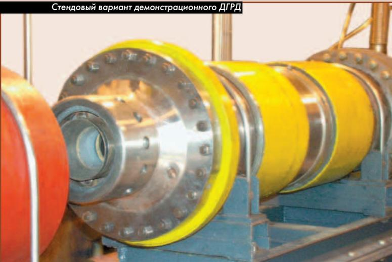
Успешному применению ГРД способствуют новые технологические и конструкционные решения: применение зарядов твердого горючего "коврового" типа (скатанный в рулон заданного диаметра лист горючего из пластичного материала), неохлаждаемые корпусов и сопловых блоков двигательных установок (ДУ), изготовленных из стеклопластиковых и композиционных материалов и др.
