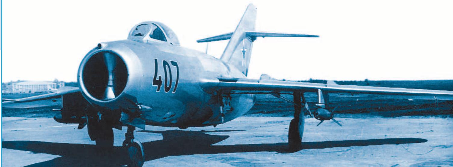
Истребитель МиГ-15бис с двумя неуправляемыми реактивными снарядами С-21
