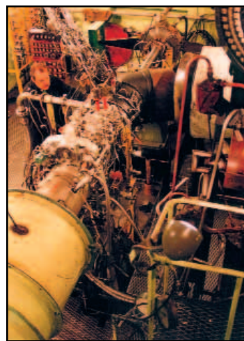
На испытательном стенде ТВ3-117
