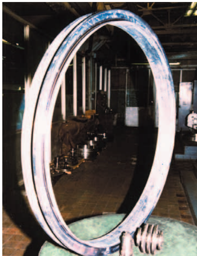
Рис. 4. Корпусная конструкция после ЭЛС
