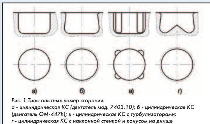
Рис. 1 Типы опытных камер сгорания:
