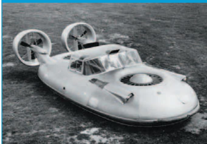
Судно на воздушной подушке с двигателем ГТД-350
