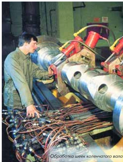
Обработка шеек коленчатого вала
