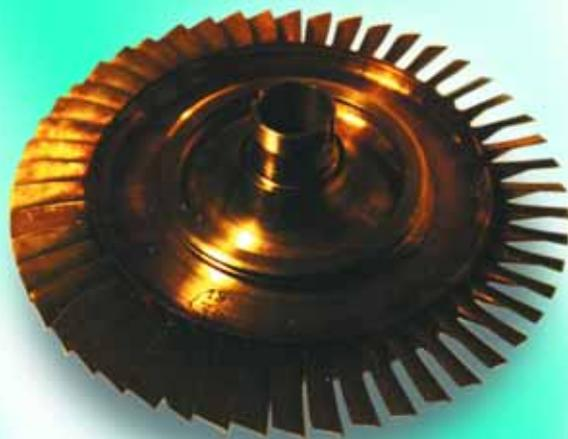
Биметаллический "блиск". Диск из порошкового сплава с лопатками из монокристаллического сплава.
