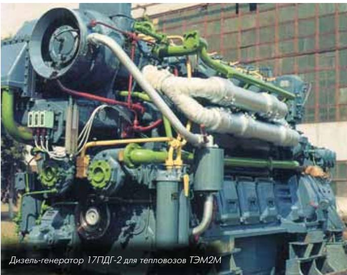
Дизель-генератор 17ПДГ-2 для тепловозов ТЭМ2М
