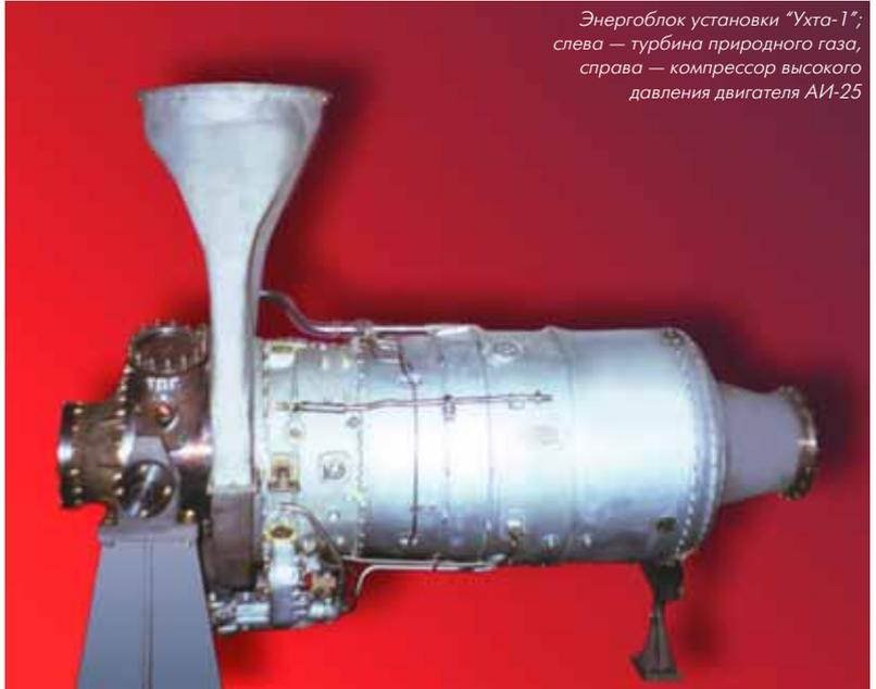
Энергоблок установки "Ухта-1"; слева — турбина природного газа, справа — компрессор высокого давления двигателя АИ-25
