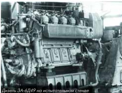
Дизель 3А-6Д49 на испытательном стенде
