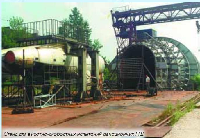
Стенд для высотно-скоростных испытаний авиационных ГТД
