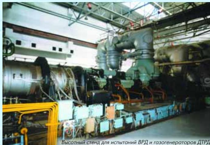
Высотный стенд для испытаний ВРД и газогенераторов ДТРД
