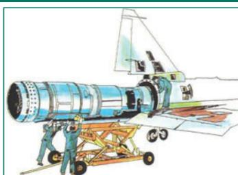
Рис. 1.15 Монтаж двигателя RM8A на самолёт JA37
