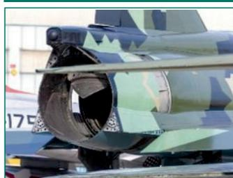
Рис. 1.14 Реверсивное устройство двигателя RM-8A
