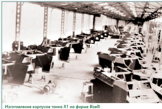
Изготовление корпусов танка X1 на фирме Biselli
