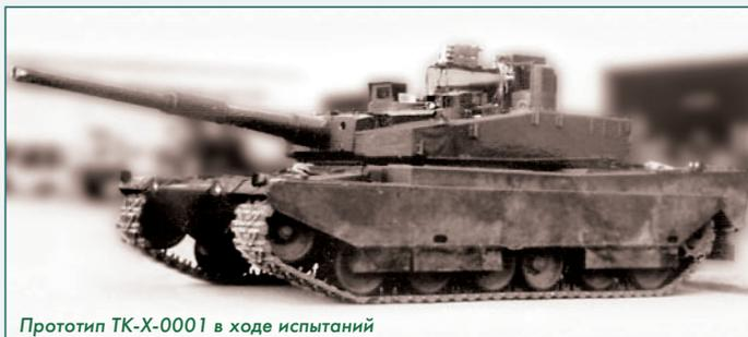
Прототип ТК-Х-0001 в ходе испытаний
