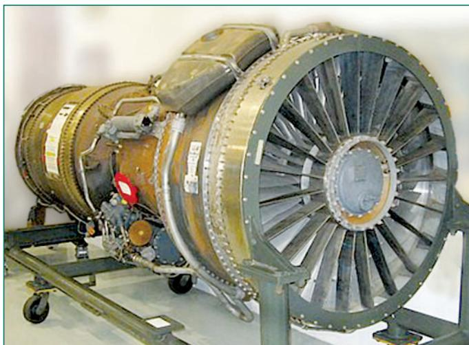
Рис. 1.6 Двигатель TF33
