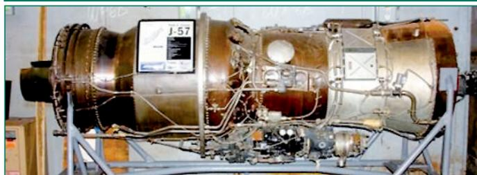
Рис. 1.2а Внешний вид двухроторного ТРД J57 (JT3A)
