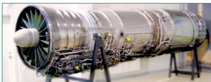
Рис. 1.12 Двигатель Volvo RM8A
