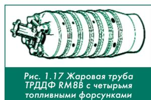
Рис. 1.17 Жаровая труба ТРДДФ RM8B с четырьмя топливными форсунками
