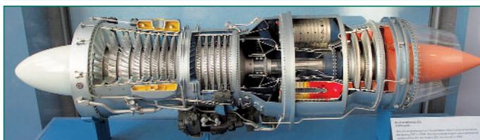
Рис. 1.3б Модель двигателя Pratt & Whitney JT3 в масштабе 1/4
