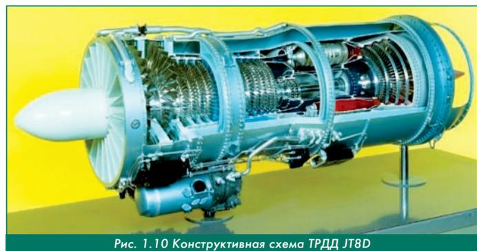
Рис. 1.10 Конструктивная схема ТРДД JT8D
