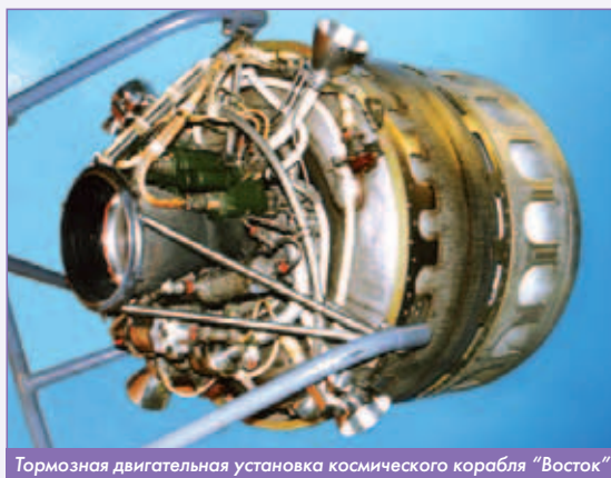
Тормозная двигательная установка космического корабля "Восток"
