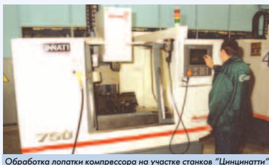
Обработка лопатки компрессора на участке станков "Цинцинатти"
