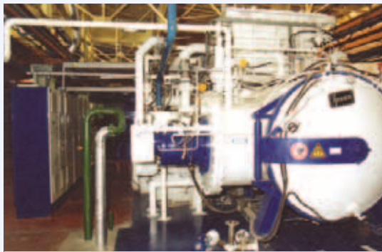
Трехкамерная печь с ЧПУ для ионного упрочнения поверхности
