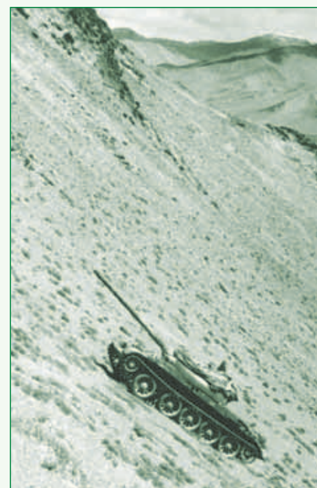
Танк Т-54 в процессе испытаний в горах
