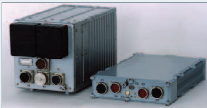
Электронная аппаратура управления ЭСУ-34 и модернизированная аппаратура управления и контроля ЭСУ-34М для воздушного винта самолета Ил-114
