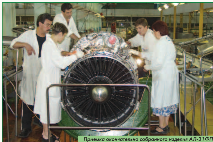
Приемка окончательно собранного изделия АЛ-31ФП
