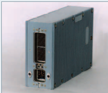
Электронная аппаратура управления (FADEC, два канала управления) ЭСУ-22 для маршевого двигателя AI-22 самолета Ту-324. Масса 6,0 кг
