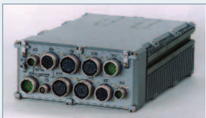
Электронная аппаратура управления (FADEC, два канала управления) и контроля ЭСУ-222 для маршевого двигателя AI-222 самолета Як-130. Масса 7,6 кг
