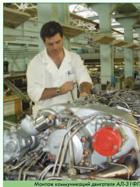
Монтаж коммуникаций двигателя АЛ-31ФП
