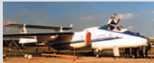
Высотный самолет М-55 с двигателями Д-30В12
