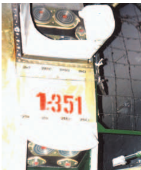
Расположение блоков двигателей стабилизации пространственного положения на станции "Алмаз"
