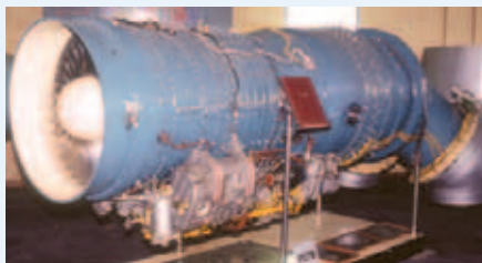
Двигатель P27B-300 для Як-38
