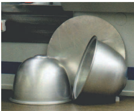
Исходная заготовка и типовые детали, получаемые ротационной вытяжкой
