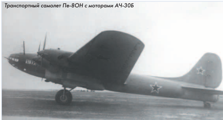
Транспортный самолет Пе-8ОН с моторами АЧ-30Б
