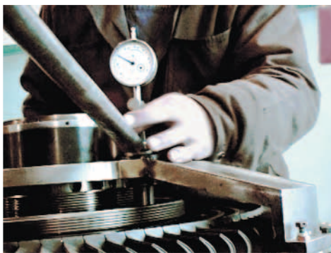
Затяжка гаек стяжных болтов с измерением величины их удлинения
